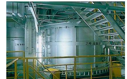
はいようゆうろ はい と きかい 灰溶融炉(灰を溶かす機械)》
